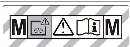
**ПРЕДОСТЕРЕЖЕНИЕ:** Этот прибор содержит опасную для здоровья пыль. Опорожнение и обслуживание, включая удаление мешка с пылью, должны проводиться только специалистами, которые имеют специальную индивидуальную защитную экипировку. Не следует включать прибор, прежде чем не установлен полный комплект системы фильтров и не проведена проверка функционирования контроля над объемом потока.
